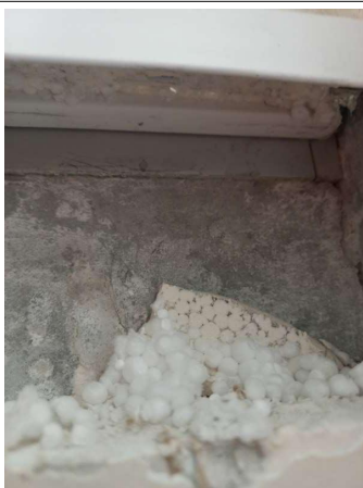
Prélèvement - P25 : MARENGO INTERNAT / R+2 / CAGE ESC 2 - Mastic- (Absence d'amiante)
