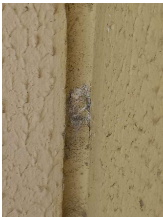
Prélèvement - P23 : MARENGO INTERNAT / R+2 / FACADES / BALCONS - Joint de dilatation- (Absence d'amiante)
