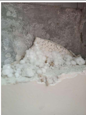
Prélèvement - P17 : MARENGO INTERNAT / RDC / CAGE ESC 1 - Plot de colle- (Absence d'amiante)
